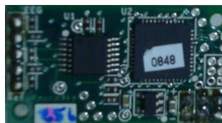
Figura 3.7: Foto do módulo ThinkGear usado
