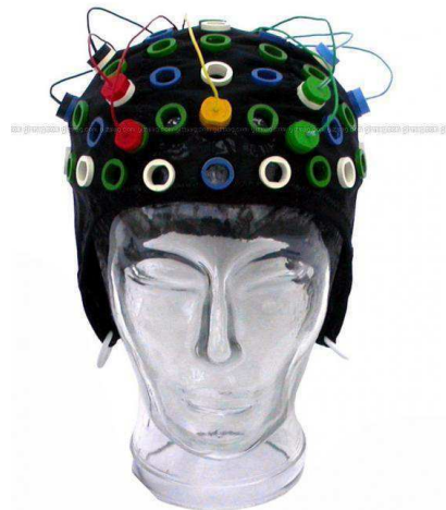
Figura 2.3: Foto de equipamento usado para adquirir os sinais cerebrais não invasivamente tipos de atividades que tendem a gerar essas características.
