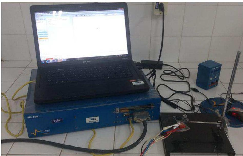
Figura 24. Imagem esquemática da célula eletroquímica conectada ao potenciostato.
