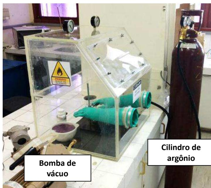
Figura 21. Imagem da câmara de vácuo.
