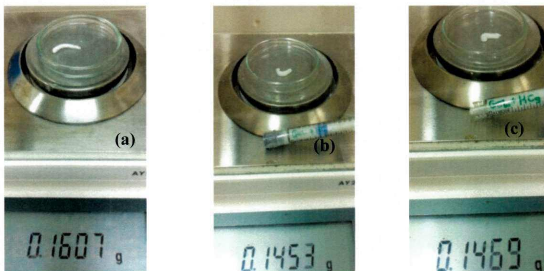
Figura 4. 9 - Mensuração do volume de 0,1 mL do hidrogel/HAp comercial e experimentais: (a) produto comercial adotado, (b) GHC e (c) GHC9.
