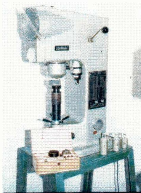
Figura 35 – Durômetro Gnehm Horgen.
