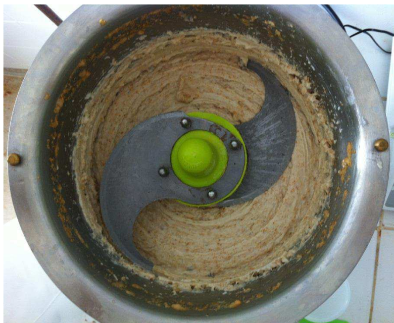
Figura 5. Emulsificação da massa cárnea no cutter.
