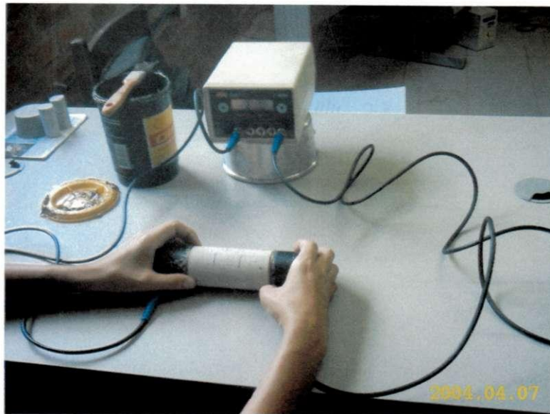
Figura 3.4 – Ensaio de ultra-som com o aparelho Ultrasonic Pulse Velocity Tester
