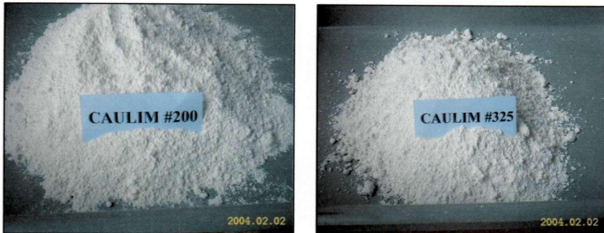
Figura 3.2 – Amostras do caulim beneficiado # 200 e #325 respectivamente
