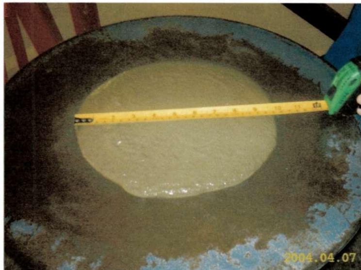
Figura 3.3 - Ensaio de consistência na mesa de fluidez
