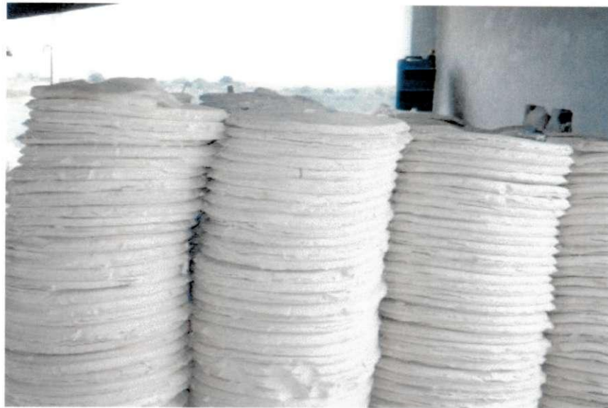
Figura 2.8 – Tortas de caulim prensadas nos filtros
