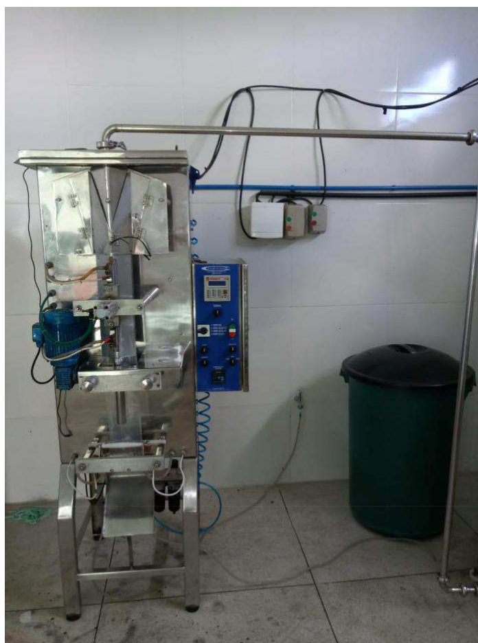
Figura 7. Ensacadora de polpa de frutas ligada diretamente ao tanque de mistura.
