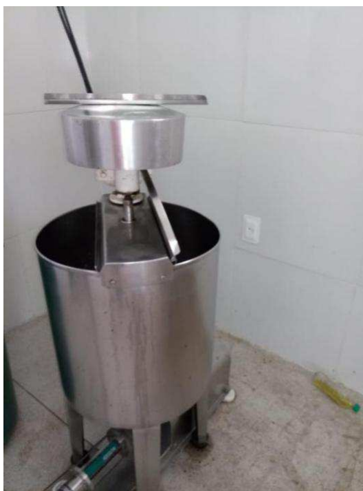
Figura 6. Tanque de mistura na produção de polpa de frutas.
