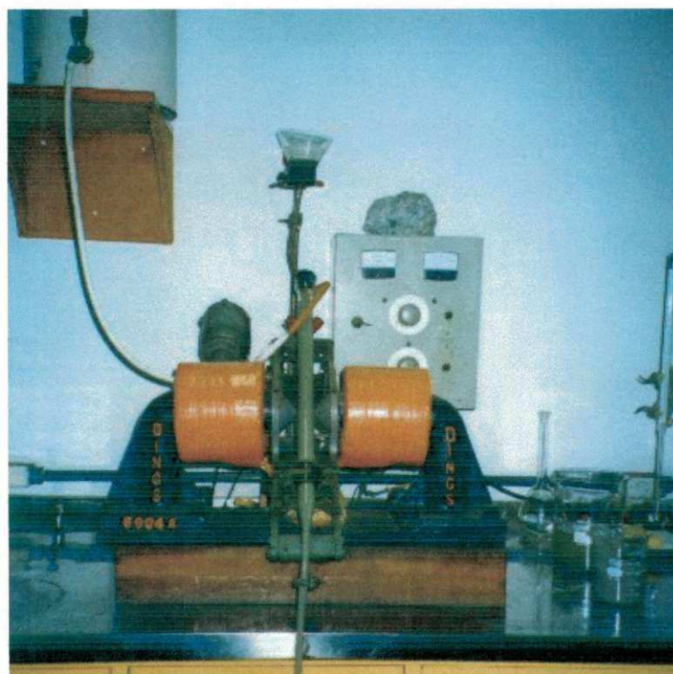
FIGURA 3.8 - Separador magnético utilizado na desferrização dos resíduos.
