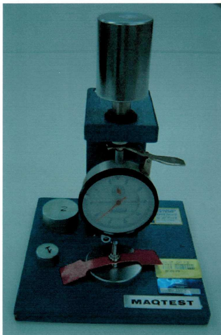
FIGURA 6: Espeçímetro composto de relógio registrador, haste para movimentação da massa de pressão, massa de pressão e base de apoio do couro.
