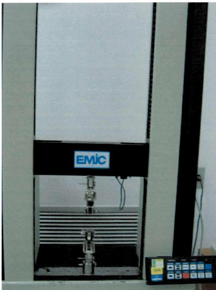
FIGURA 10. Equipamento universal de ensaio (dinamômetro) utilizado nos ensaios de tração e rasgamento, composto de haste de deslocamento ascendente ou descendente, célula de carga, garras e painel de controle.
