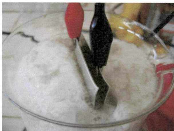
Figura 2 – Visão em tempo real da espuma gerada durante o processo de eletrocoagulação/flotação.
