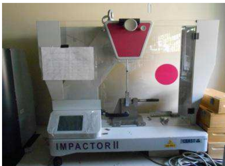
Figura 3.10: Máquina de ensaios de impacto CEAST IMPACTOR II. Fonte: Autoria própria.
