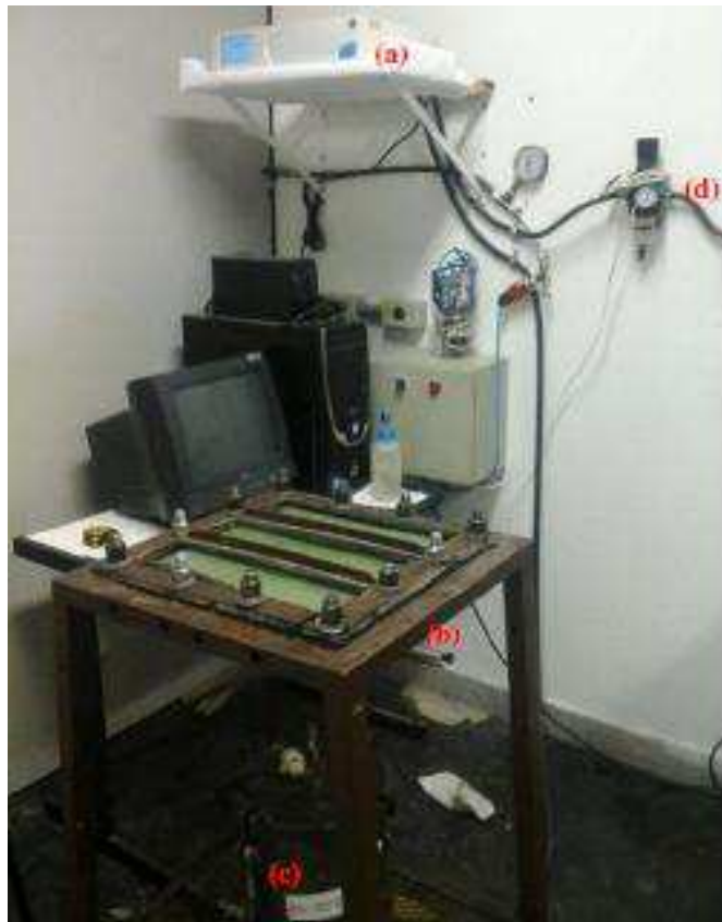
Figura 3.2: Aparatos do sistema RTM: controlador e regulador de pressão (a), molde (b), vaso de pressão (c) e filtro regulador de pressão de ar (d).
