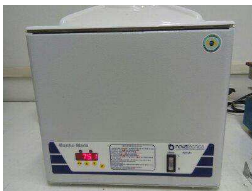
Figura 3.6: Equipamento conhecido como banho Maria utilizado para ensaio higrotérmico. Fonte: Autoria própria.
