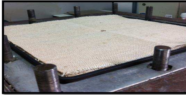
Figura 3.4: Camadas de tecidos juta/algodão inseridos no molde RTM com orifício central. Fonte: Autoria própria.
