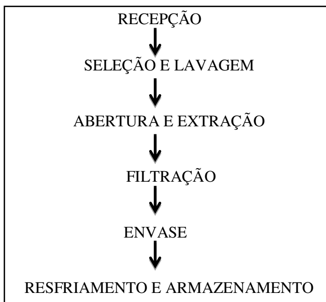
Figura 3.1 - Etapas do processo de produção da água de coco verde refrigerada, envasada pelas indústrias avaliadas.
