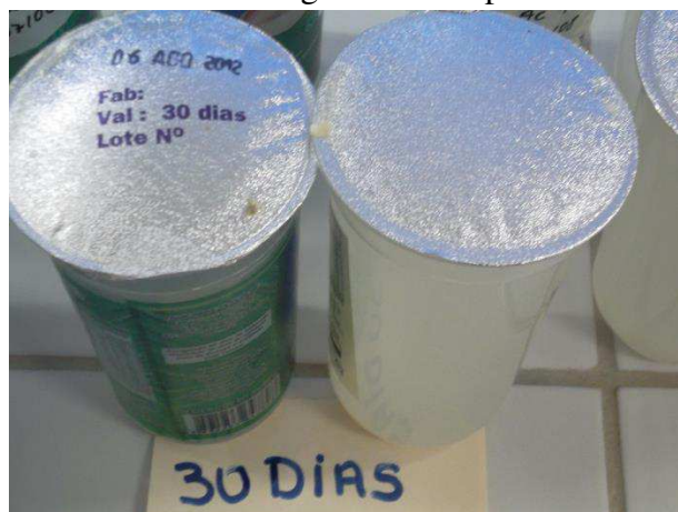
Figura 4.8 - Armazenamento de água de coco processada pelas indústrias com 30 dias de armazenamento refrigerado a temperatura 12 °C
