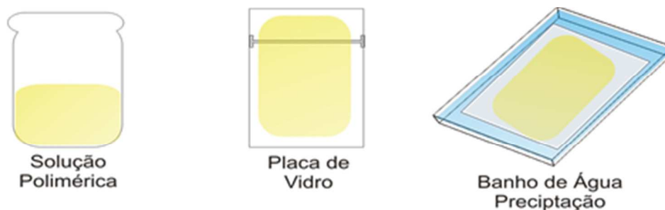
Figura 8: Representação esquemática das etapas envolvidas na formação de membranas por imersão em banho de não-solvente.
