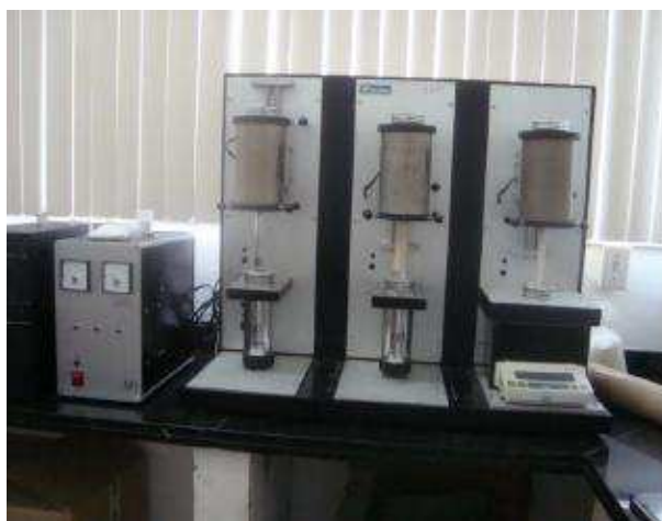
Figura 3.8 – Equipamento utilizado para as análises térmica e gravimétrica.
