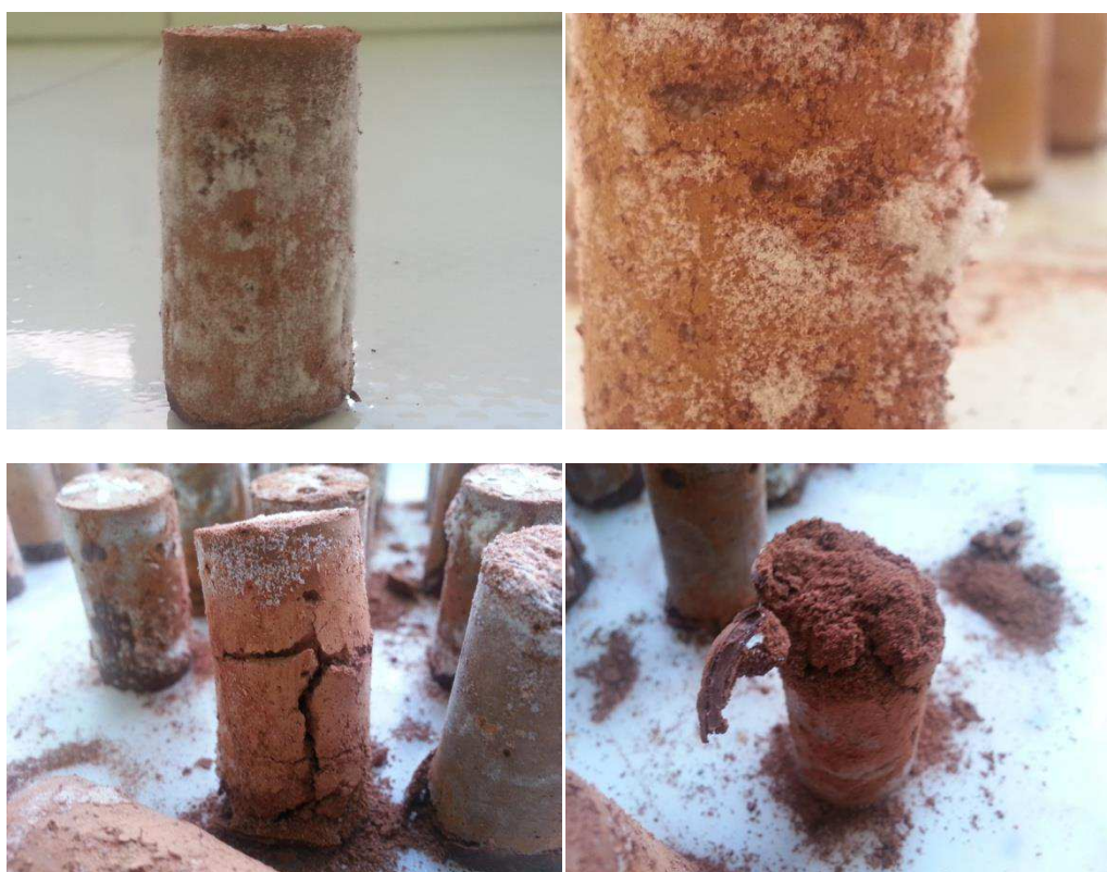
Figura 21 – Evolução do processo de deterioração dos corpos de prova ativados com KOH
