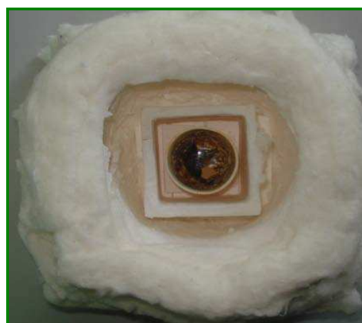
Figura 15 - Manta e suscepter usado no auxílio ao aquecimento.
