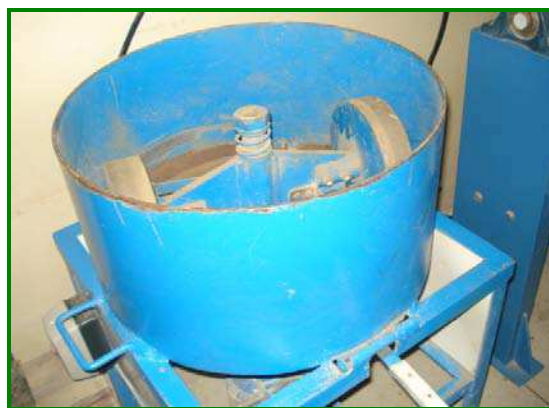
Figura 12 - Moinho de galga usado na moagem. Fonte: própria.
