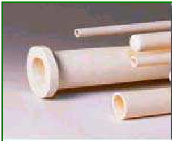
Figura 3 - Tubos de mulita utilizados em fornos.
