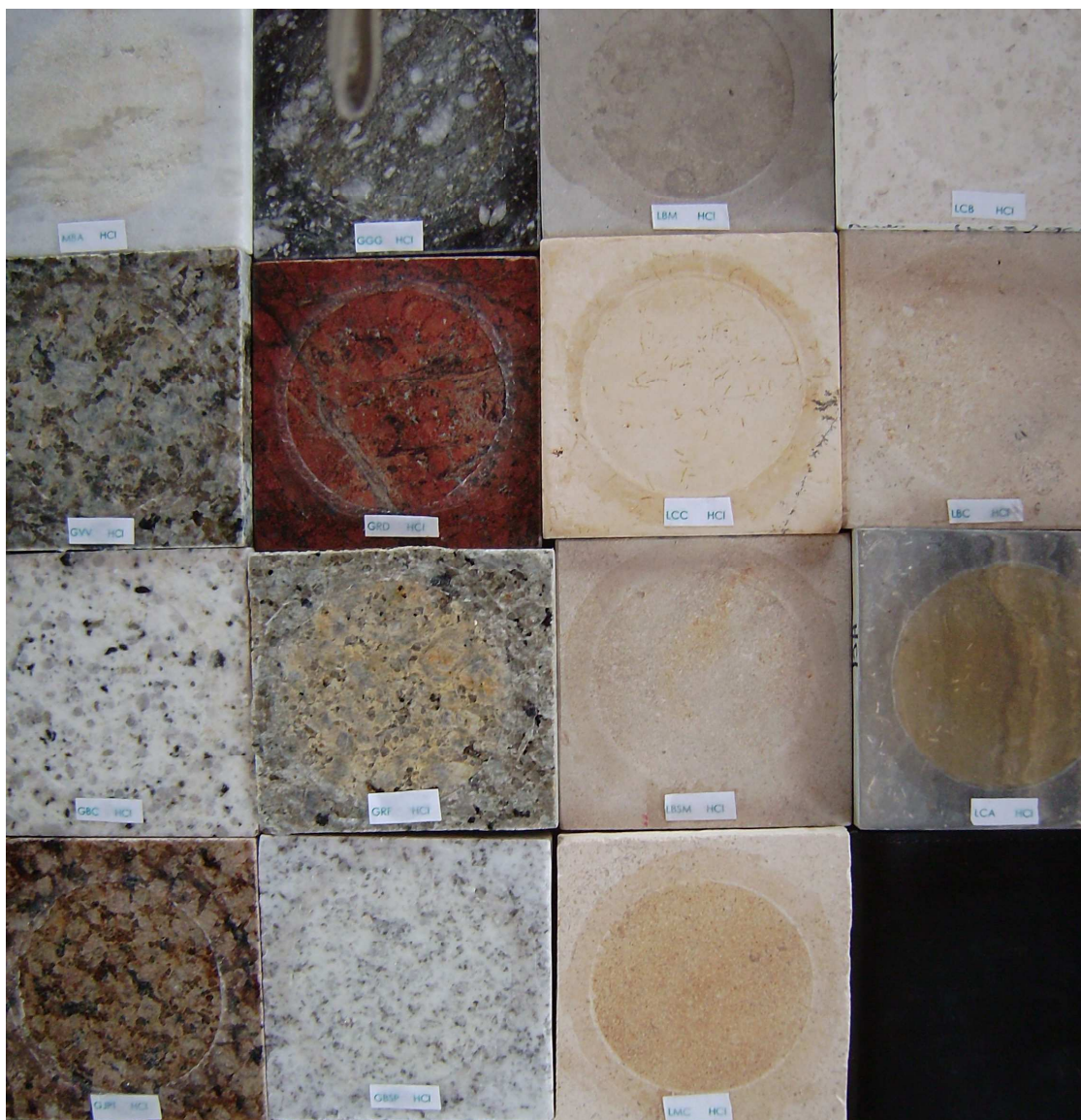
Figura 4.13. Fotografias das amostras analisadas após exposição ao ácido clorídrico
