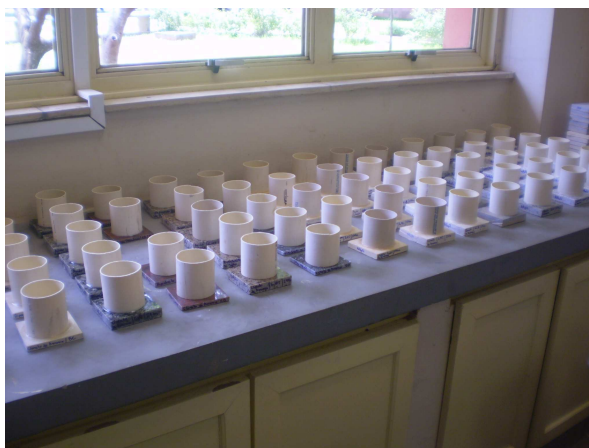
Figura 3.4. Arranjo utilizado para o ensaio de alterabilidade
