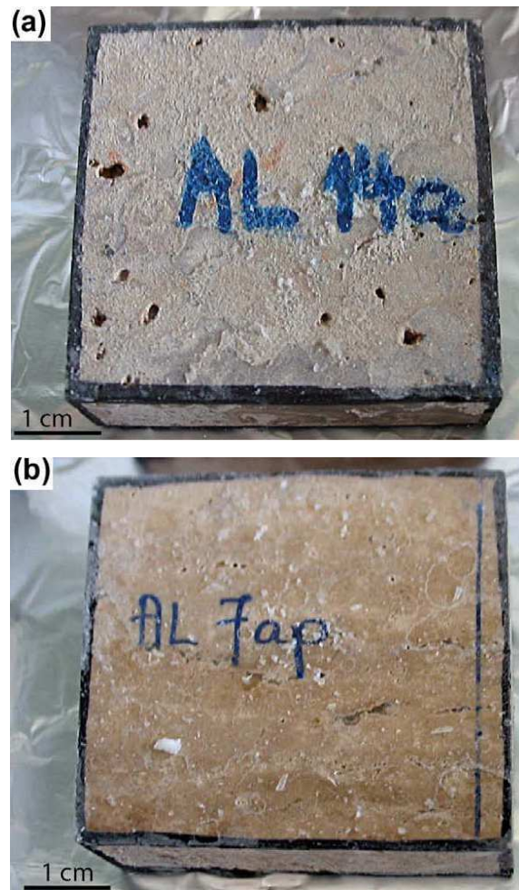
Figura 2.7. Características macroscópicas da superfície do travertino após ensaio de envelhecimento com a névoa salina a) rugoso e b) polido (UROSEVIC et al. 2010)
