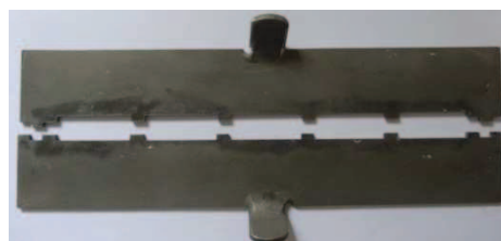
Figura 6: (a) Molde bi-partido encaixado; (b) Molde separado para remoção das amostras.
