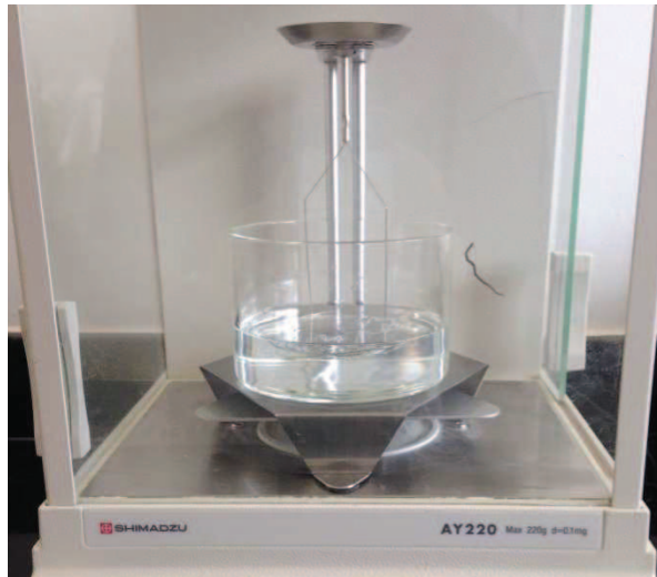
Figura 11: Balança analítica com aparato para pesagem em peso imerso ( P_i ), comparativamente peso seco ( P_s ) e peso úmido ( P_u ).
