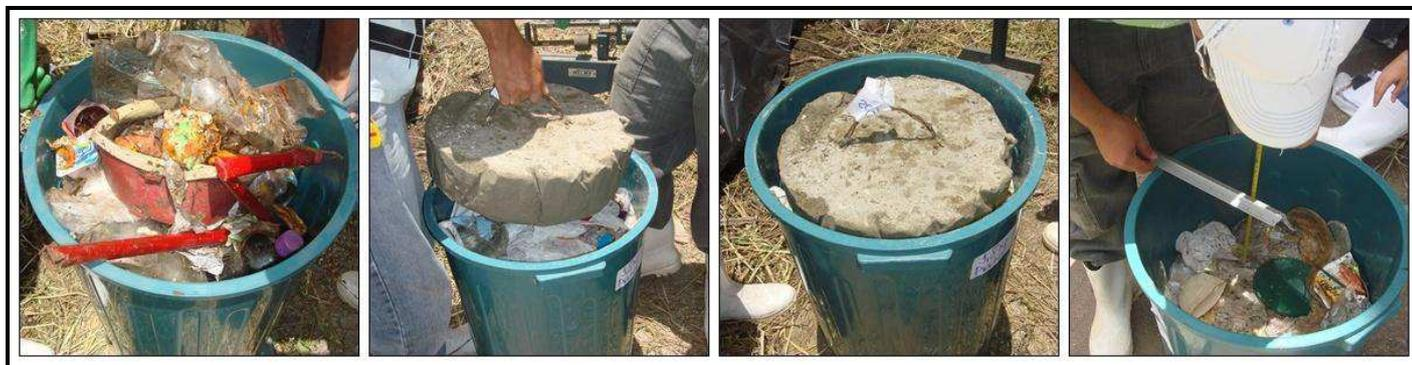
Figura 12: Determinação da composição volumétrica.
