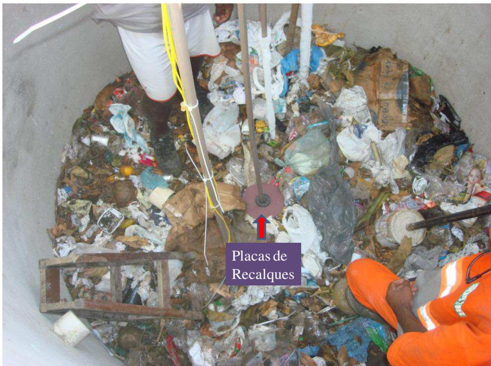
Figura 9: Medidores de recalques superficiais e em profundidade
