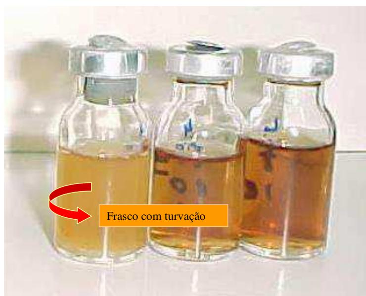
**Figura 23: Ensaio para Anaeróbios Totais**
