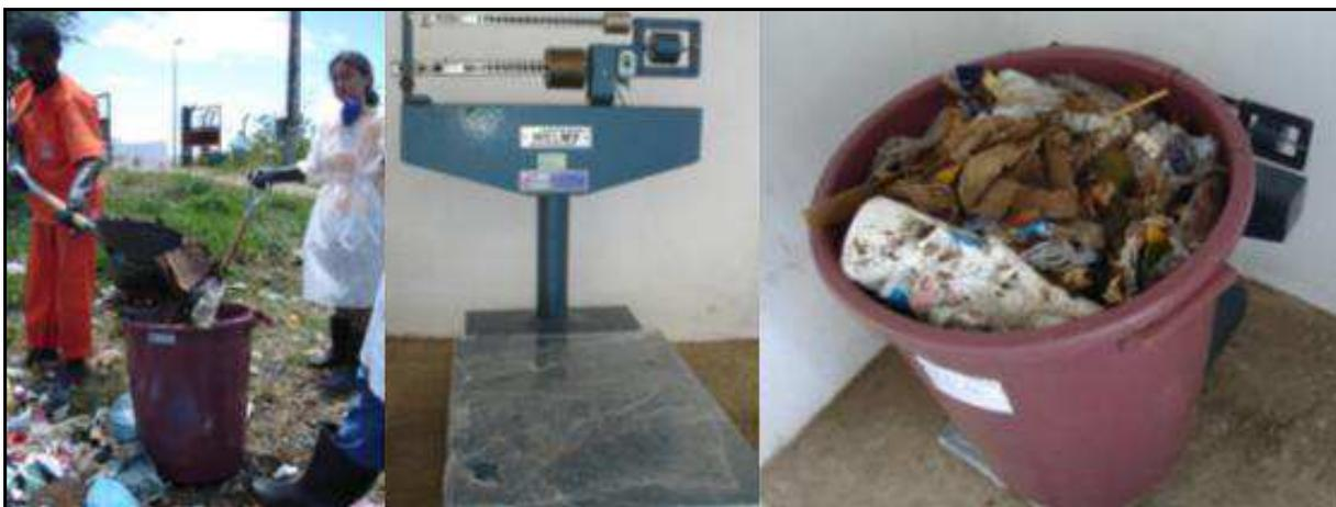
Figura 13: Determinação da massa específica solta dos resíduos
