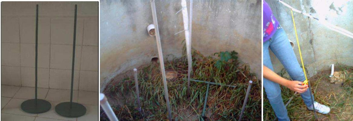
**Figura 15: Placas de recalque seperficiais e dispostas sobre a camada de cobertura da célula experimental**
