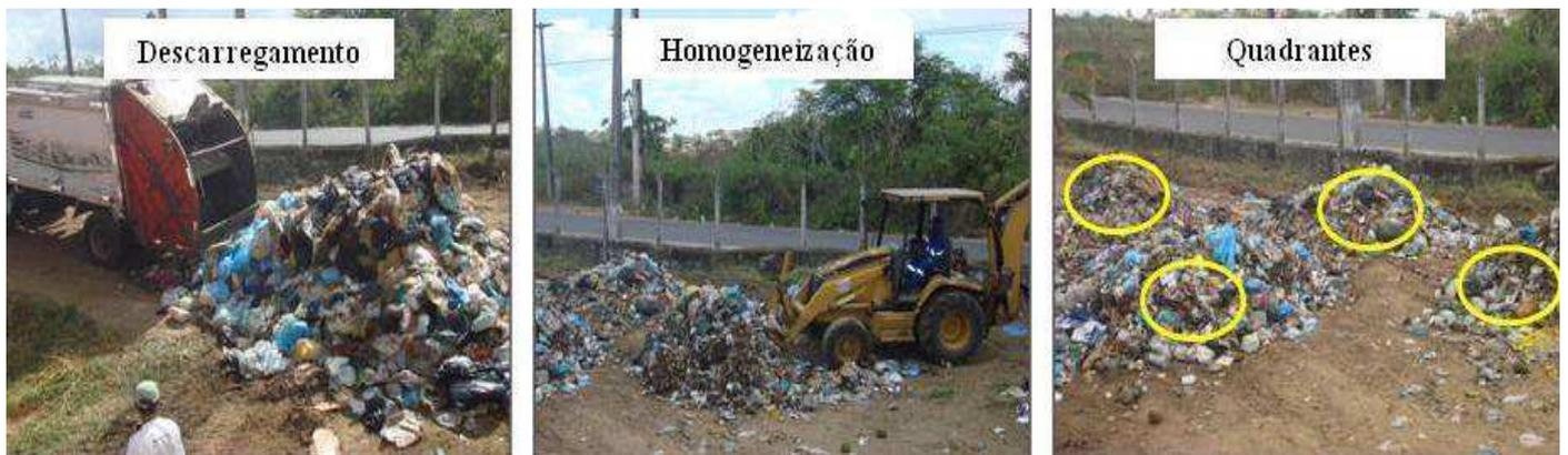
Figura 14: Descarregamento, homogeneização do material e divisão das pilhas
