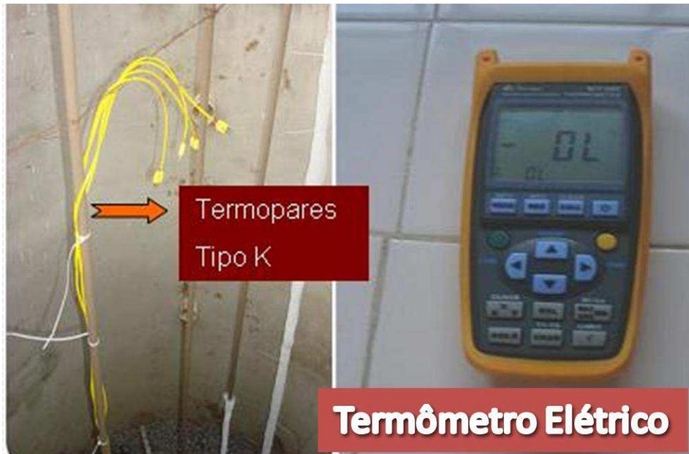
Figura 8: Quatro termopares do tipo K e termômetro elétrico
