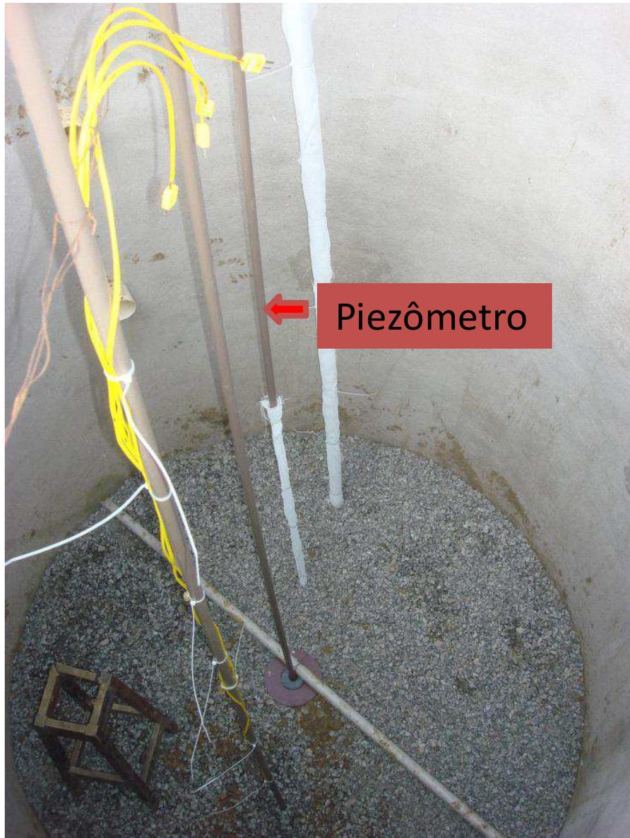
**Figura 7: Piezômetro para o monitoramento do nível de líquidos**
