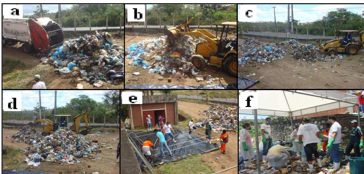
**Figura 11: Procedimentos para determinação da composição gravimétrica dos RSU**
