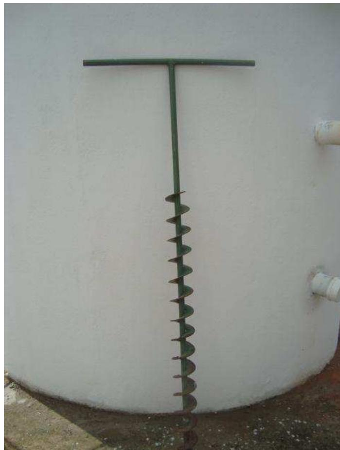
**Figura 19: Amostrador(Trado helicoidal) para retirada de amostras dos resíduos nos orifícios laterais**
