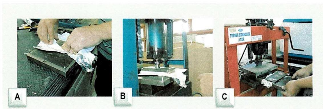
**Figura 143 – A) Mistura das matérias primas B) Prensagem a frio C) Prensagem a quente
