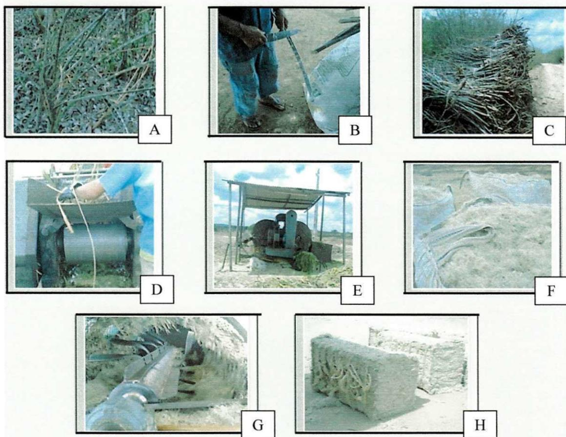
Figura 12 – A) Caroá B) Extração e corte manual do caroá C) Secagem do caroá a céu aberto D) Desfibramento E) Tesouramento F) Fibras de caroá G) Batimento H) Fardos de fibras de caroá FOTOS: Ana Flávia Câmara Bezerra
