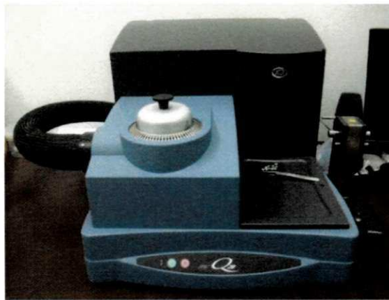
Figura 4.5 – Equipamento de Calorimetria Exploratória Diferencial (DSC). Fonte: Própria
