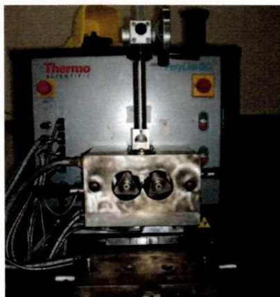
Figura 4.3 - Misturador interno acoplado ao reômetro de torque Haake Rheomix 3000QC da PolyLab QC.
