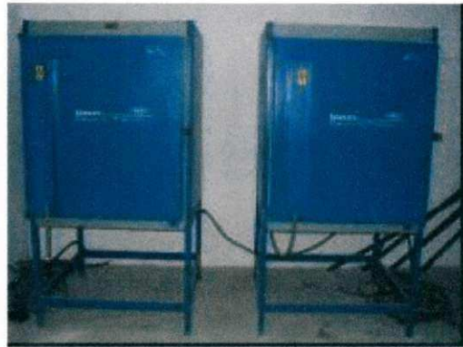
Figura 10 b. Fornos para a cura da argamassa.
