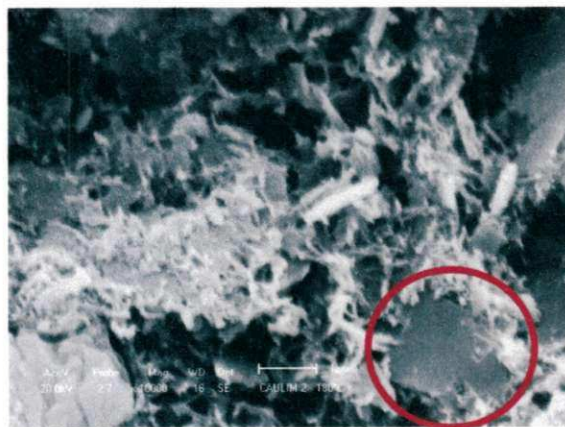
Figura 49. MEV da argamassa com resíduo do caulim a 180°C. (1µm)
