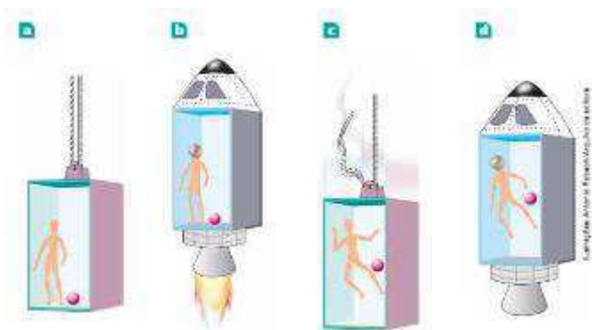
Figura 11 - A equivalência das leis físicas em um elevador parado (a) comparado com nave acelerada (b) com aceleração g , em (c) um elevador em queda livre acelerado para baixo, equivale a nave livre de campo gravitacional (d) – Fonte: Beatriz Alvarenga (2013).
