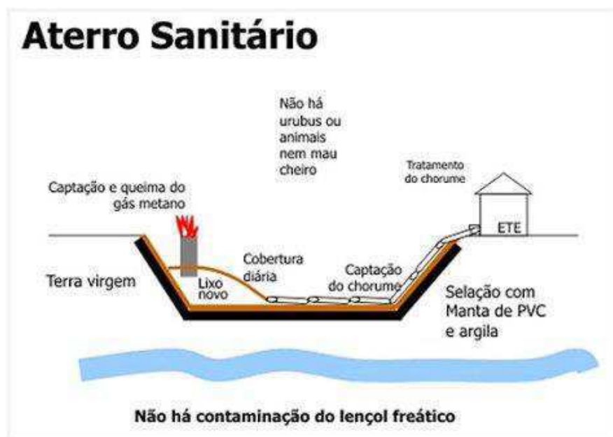
Figura.02- Estrutura do Aterro Sanitário.
