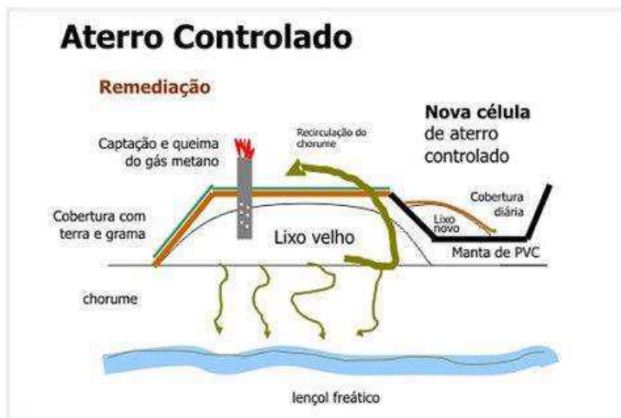
Figura 03- Estrutura do Aterro Controlado.
