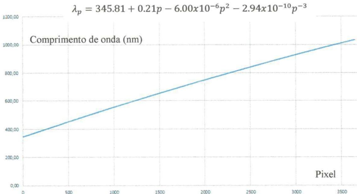
**Figura 5.1** – Gráfico Comprimento de Onda x Pixel
