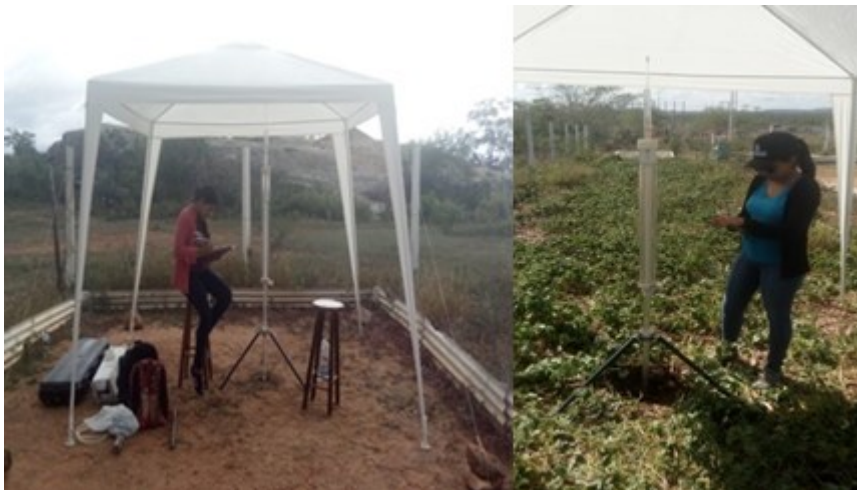
Imagem 3 - Ensaios de infiltração usando o Permeômetro de Guelph
