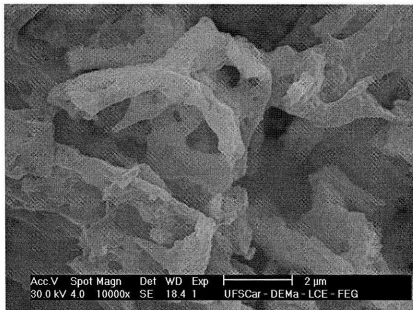
Figura 13. Características morfológicas obtidas por MEV dos pós de ferrita Mn-Zn para o sistema S01 utilizando a relação RT:H 2 O de 1:25, obtidos por reação de combustão (20.000 X).
