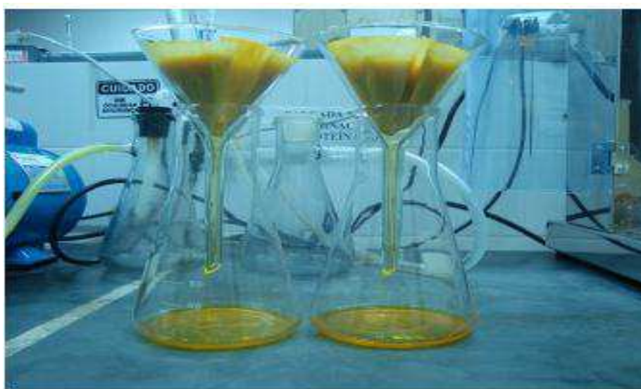
Figura 7: Extração do óleo de pequi com solventes, etapa de filtração.
