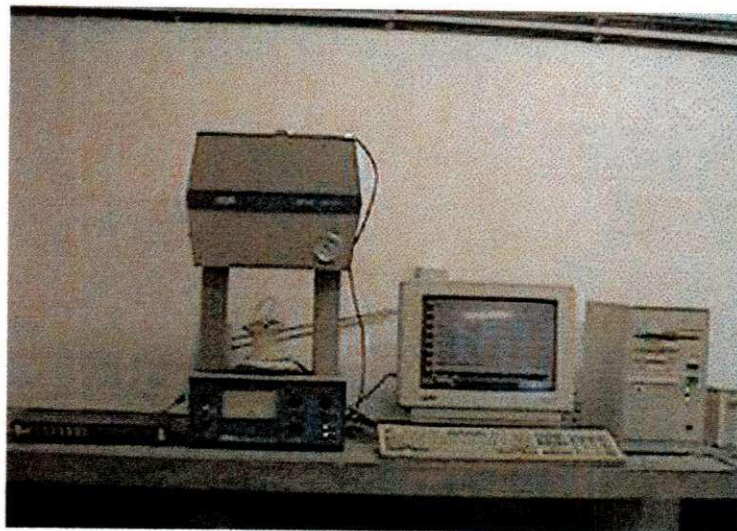
Figura 3.2 – Forno tipo mufla vertical de aquecimento resistivo e sistema de aquisição de dados.
