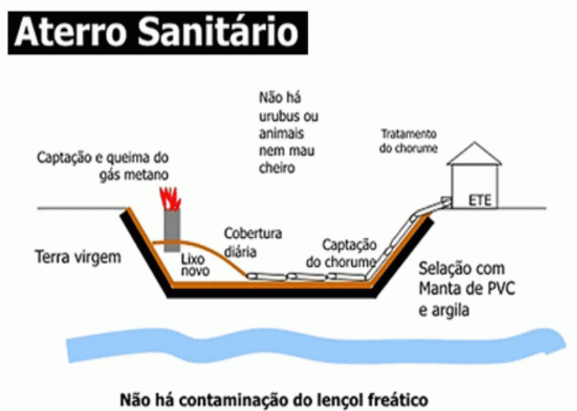
Figura 3. Esquema de um aterro sanitário
