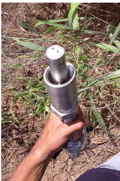
Figura 21-Imagem do transdutor do macromedidor de inserção com deposição de materiais.
