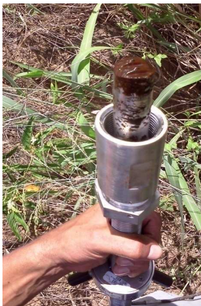
Figura 20-Imagem do transdutor do macromedidor de inserção com deposição de materiais.
