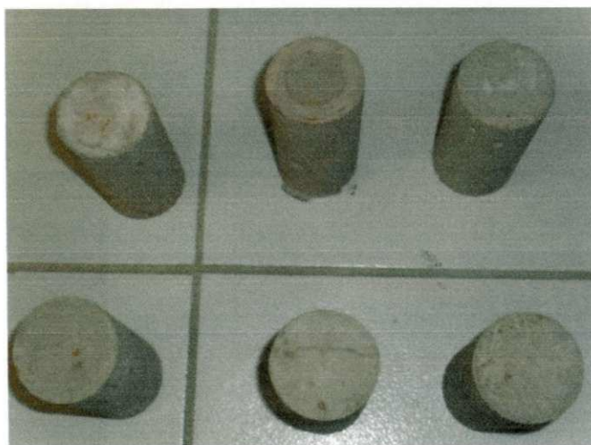
Figura 7 - Corpos de prova após a estabilização por solidificação
