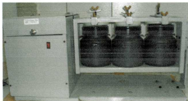
Figura 8 - Vista Frontal do Aparelho Rotativo de Frascos para Lixiviação
