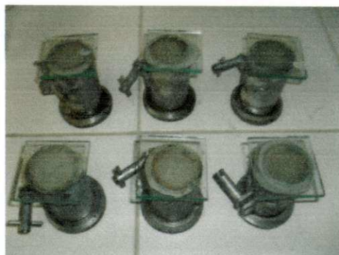
Figura 5 - Moldagens dos corpos de prova (cilindro 5x10cm)
