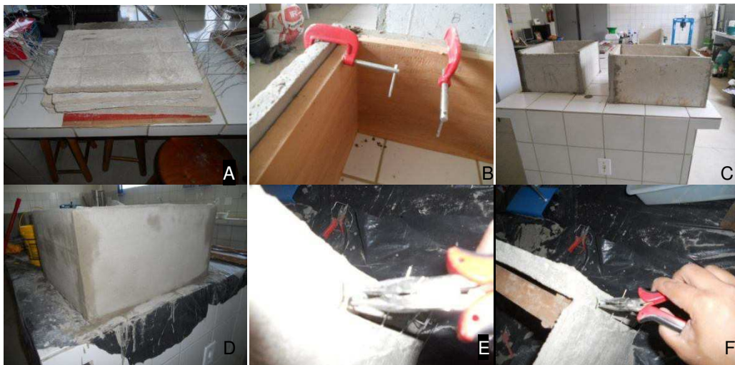
Figura 13 – Montagem das colmeias de concreto. A Separação das placas, B Fixação das placas na caixa de montagem, C Fechando as laterais D Lateral do ninho devidamente fechado E e F Corte das sobras do arame
