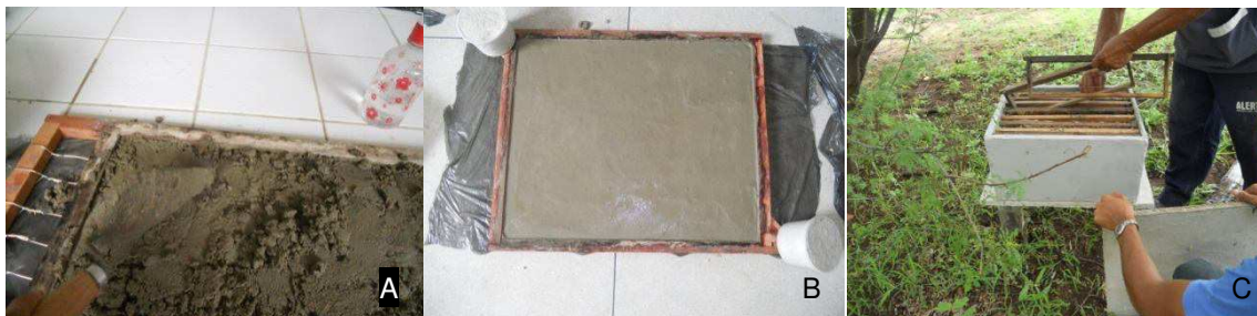
Figura 11 – Preenchimento das formas com o concreto. A Preenchimento da forma frontal com a ripa, B Forma da tampa com a massa devidamente lisa, C Verificação do encaixa do quadro e formação de fendas
