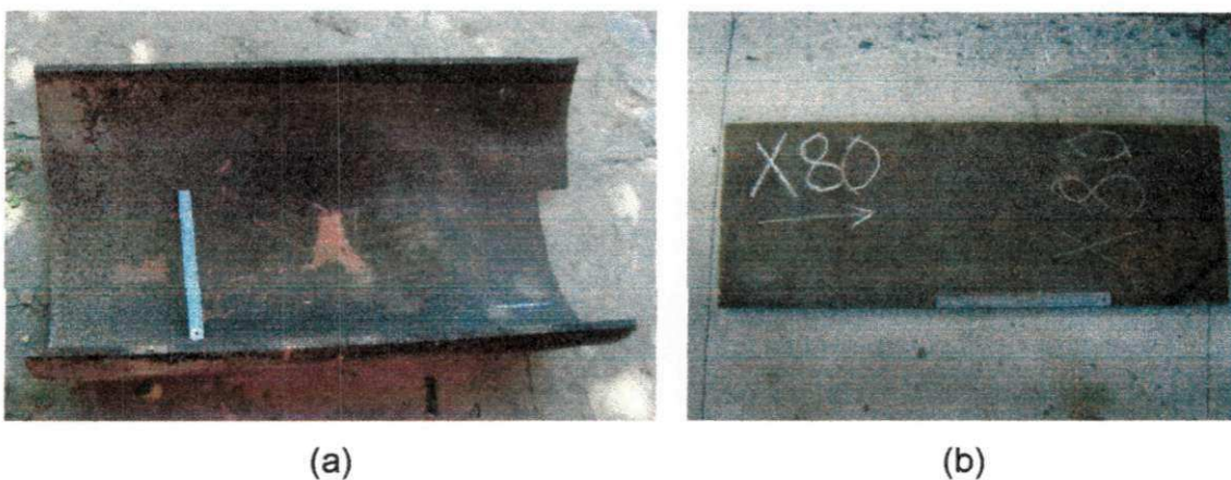
Figura 10: (a) Foto da tubulação de aço API 5L X60 utilizada para retirada dos corpos de prova e (b) Foto da chapa de aço API 5L X80 utilizada para retirada dos corpos de prova.
