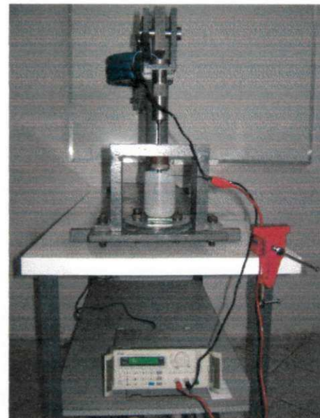
Figura 17: Dispositivo desenvolvido para a realização das hidrogenações sob tensão (Costa, 2008).
