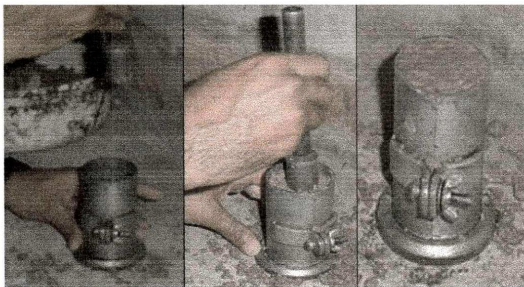
FIGURA 3.16 - Moldagem dos corpos-de-prova tipo 1
