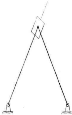
Figura 2.1 c–Movimento relativo de dois planos unidos através de corredeira (Inversão do mecanismo biela-manivela).
