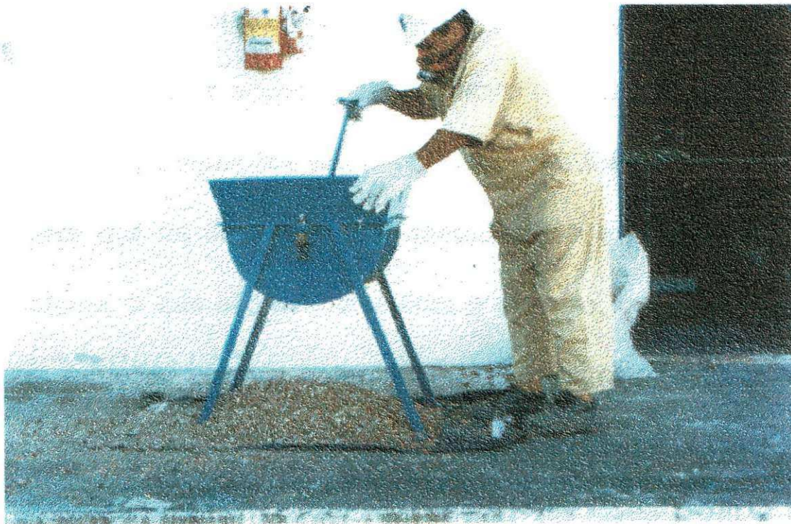
Figura 2.8 Máquina manual em operação de descascamento
