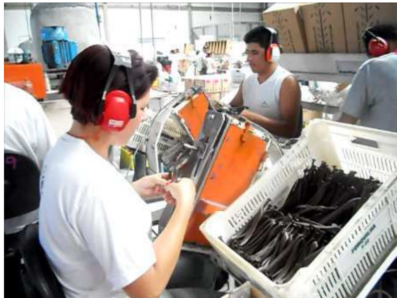
Figura 3.11 – Equipamento utilizado para inserir a forquilha no calçado. Local onde foi realizada a 7ª medição.
