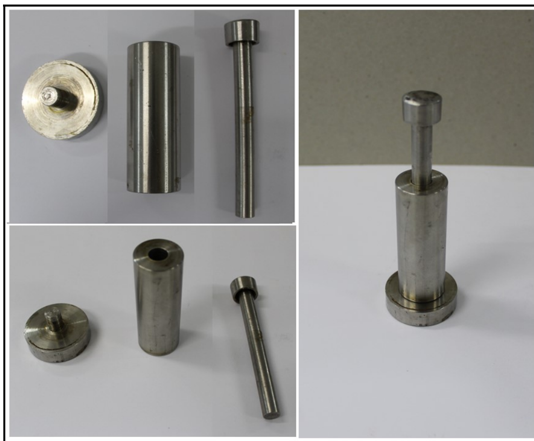
Figura 2 – Equipamento de compressão – Conjunto de matrizes e punções
