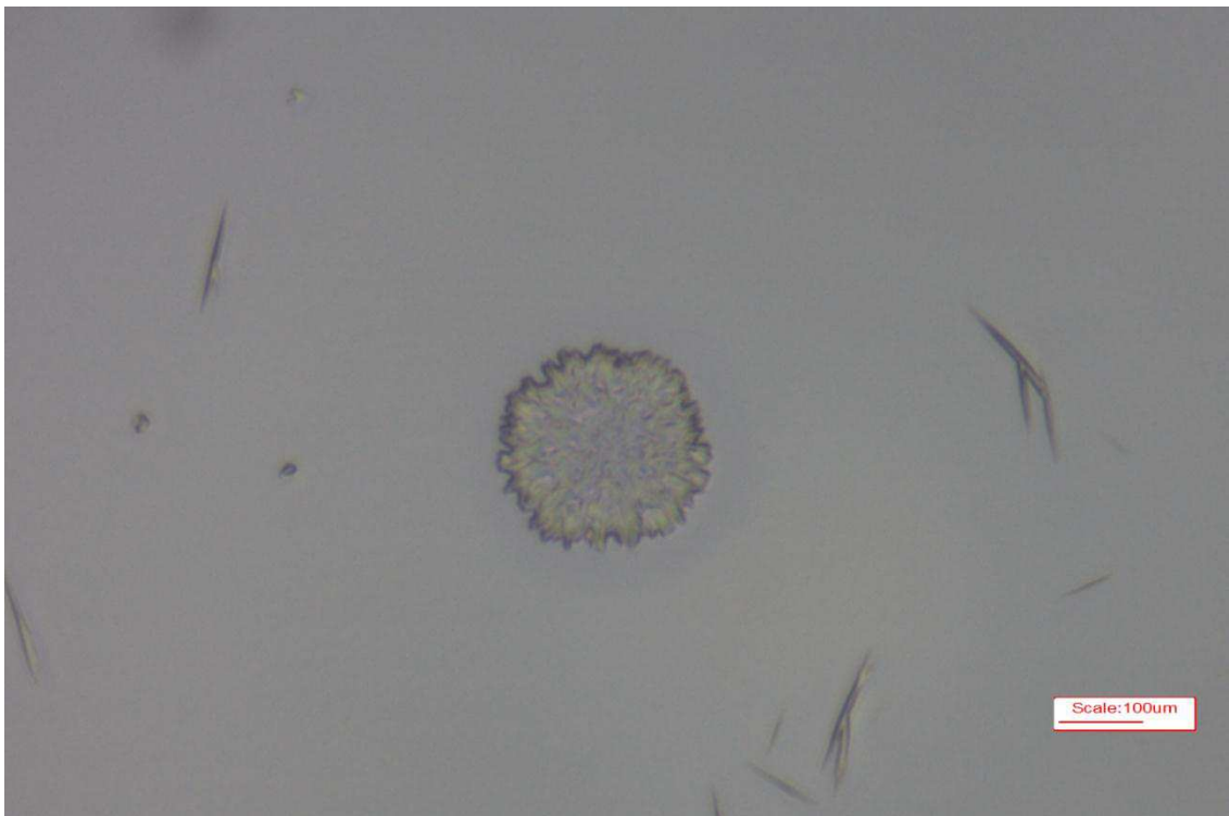
Figura 6: Microcápsula obtida pela formulação F1-A, objetiva de 40.
