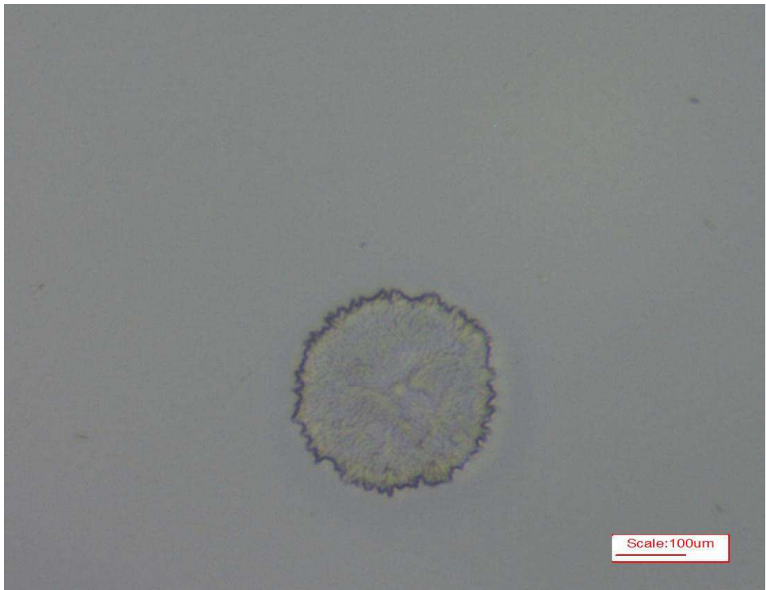
Figura 11: Microcápsula obtida pela formulação F2-A, objetiva de 40.
