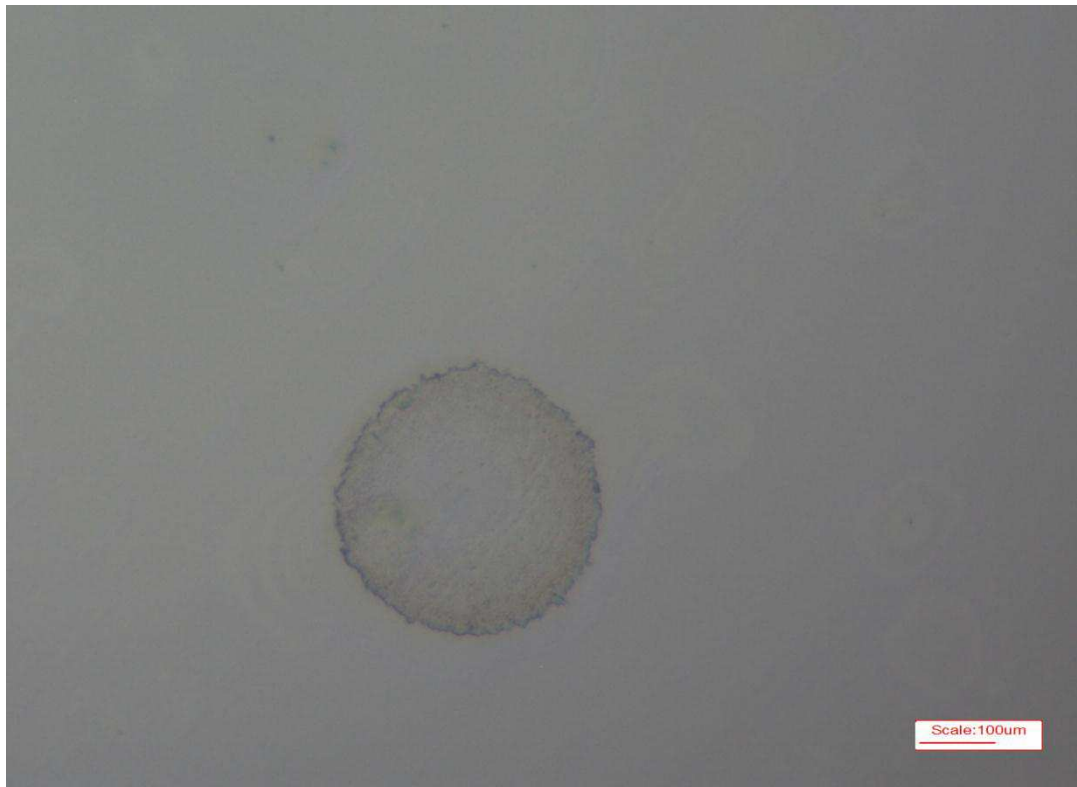
Figura 12: Microcápsula obtida pela formulação F3, objetiva de 20.
