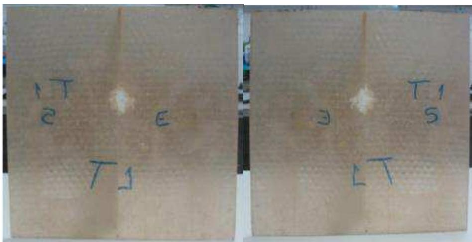
Figura 4.12 – Placa de 1 camada de tecido de fibra de vidro (T1).
