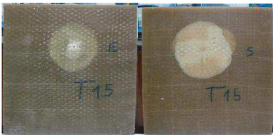
Figura 4.15 – Placa de 15 camadas de tecido de fibra de vidro (T15).
