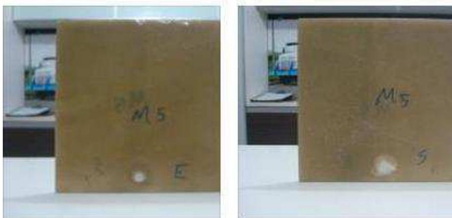
Figura 3.3 – Placa de compósito com manta de fibra de vidro como reforço. A figura mostra o local do dano.
