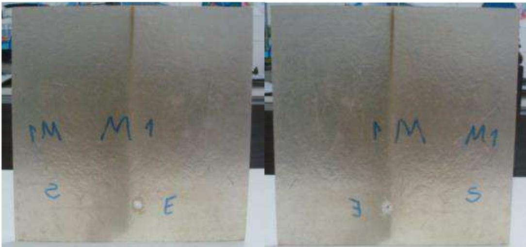
Figura 4.6 – Placa de 1 camada de manta de fibra de vidro (M1).
