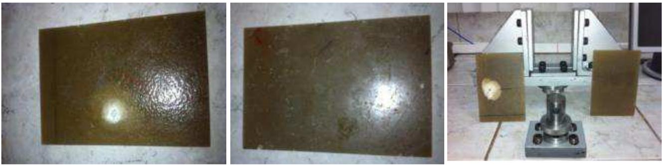
Figura 3.18 – Corpos de prova, com e sem dano, para realização do ensaio de Compressão Após Impacto.
