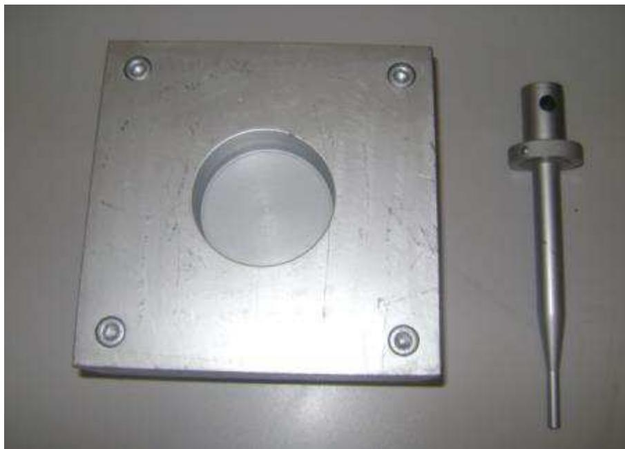
Figura 3.8 – Aparato de testes para ensaio quase-estático Punch Shear.
