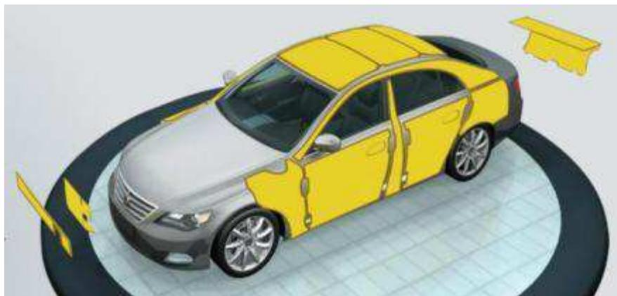
Figura 2.2 – Kit de Blindagem da DuPont chamado de Dupont Armura®, mostrando a alocação dos painéis balísticos. Fonte: DuPont Brasil.
