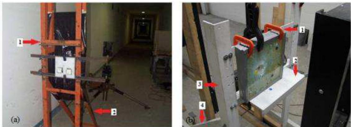
Figura 3.5 – Alguns modelos analisados de suporte de fixação das placas para ensaio Balístico, (a) e (b).
