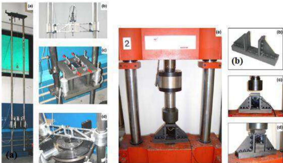
Figura 2.16 – (a) Máquina de impacto, (b) Garra CAI baseada na norma ASTM D7137. Fonte: Ghelli e Minak (2011).
