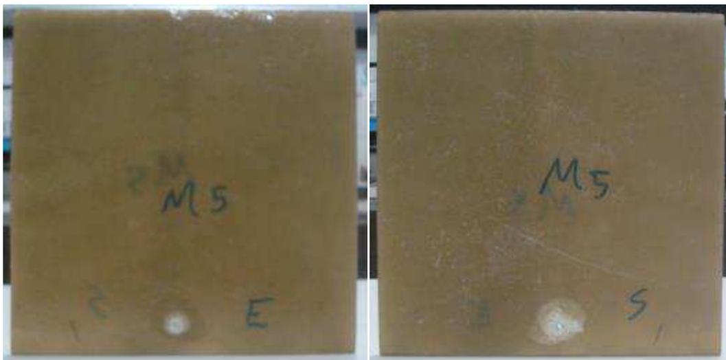
Figura 4.7 – Placa de 5 camadas de manta de fibra de vidro (M5).
