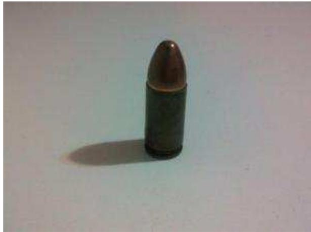
Figura 3.15 – Munição CBC 9 mm Luger utilizado no Ensaio Balístico.
