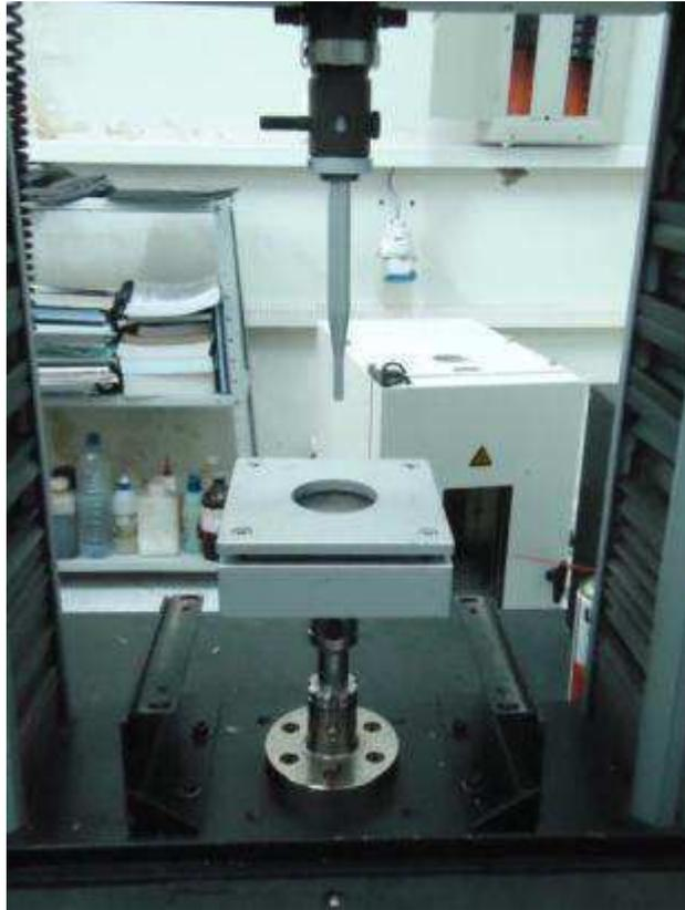
Figura 3.17 – Aparato para ensaio quase-estático Punch Shear fixado na máquina Instron.
