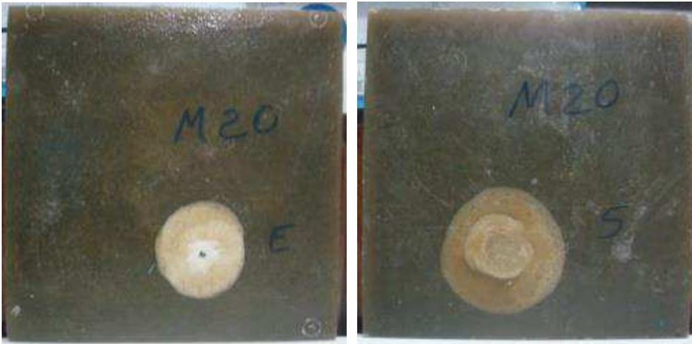
Figura 4.10 – Placa de 20 camadas de manta de fibra de vidro (M20).
