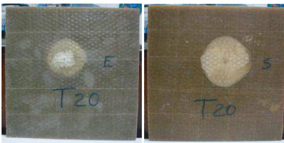
Figura 4.16 – Placa de 20 camadas de tecido de fibra de vidro (T20).
