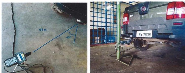
Ligar o tacômetro na bateria do veículo, cuidando com a polaridade, engate vermelho no positivo da bateria e o preto no negativo da bateria.
