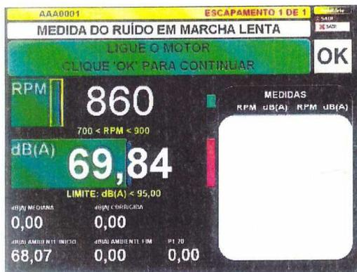
15 - Acelerar o motor dentro da faixa especificada, neste caso entre 2800 e 3200 RPM, programa medirá o ruído em aceleração.
