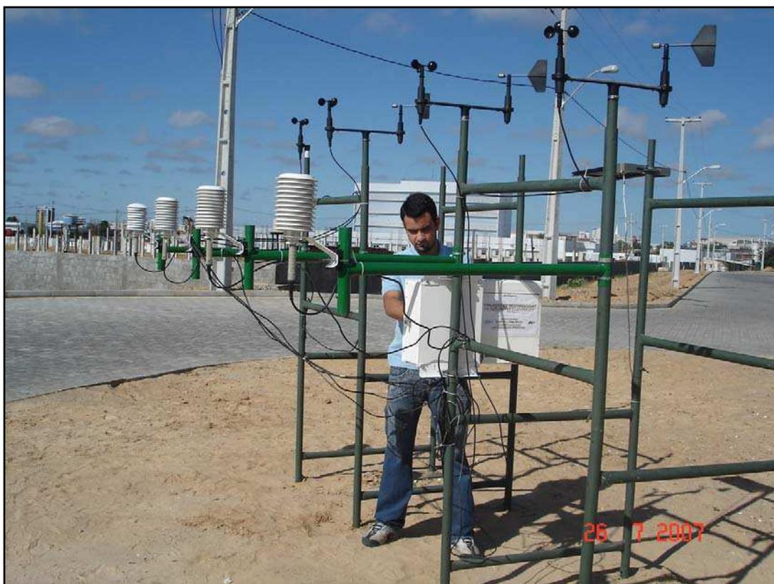
**Figura 09:** Calibração prévia dos sensores.
