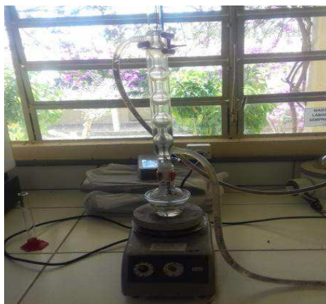
Figura 13. Reação de esterificação do ácido esteárico
