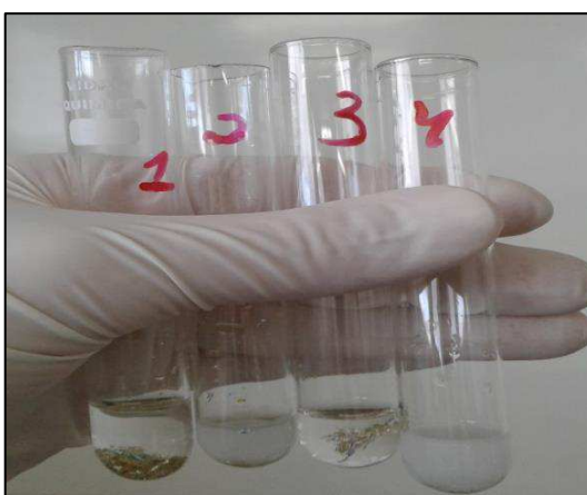
Figura 24 – Testes qualitativos para determinação de alumínio e seus compostos
