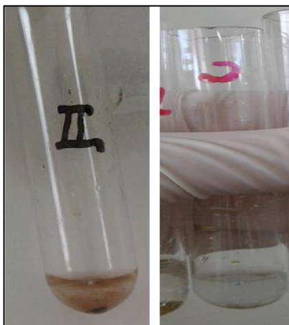
Figura 25 – Comparação entre os metais dos CD-Rs (esquerda) e dos CDs (direita) ao reagirem com NaOH
