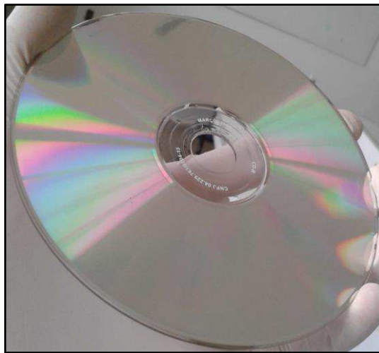
Figura 13 – Camada metálica exposta de um CD-R
