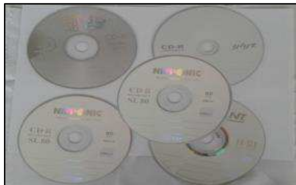
Figura 9 – CD-Rs utilizados nos testes de concentração de NaOH para remoção das camadas de tinta e de verniz
