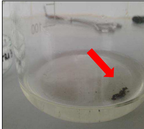
Figura 15 – \text{Ag}_2\text{O} formado em solução de \text{NaOCl}
