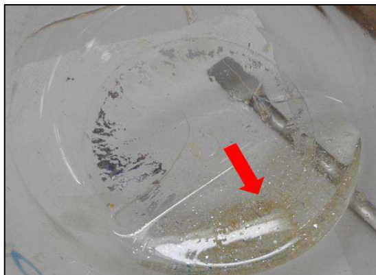
Figura 23 – Material formado na solução de NaOH com alumínio metálico de CD
