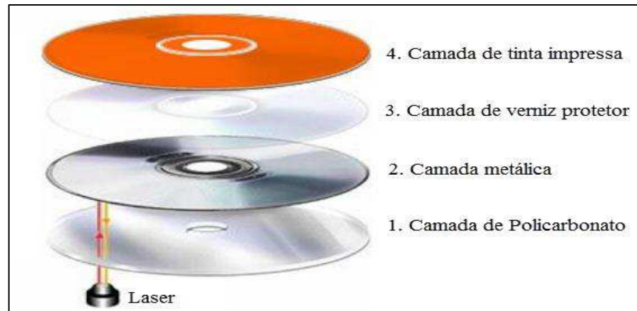
Figura 1 – Representação esquemática das camadas de um CD
