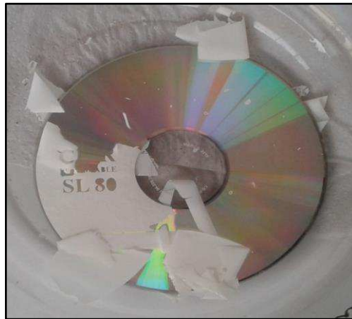
Figura 11 – Remoção da camada de tinta e verniz por NaOH em um CD-R
