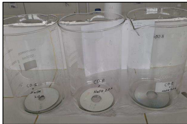
Figura 8 – Béqueres contendo amostras de CD-Rs e NaOH
