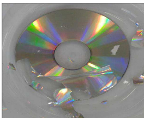
Figura 17 – Remoção da camada metálica de um CD-R por NaOH 6,0 M
