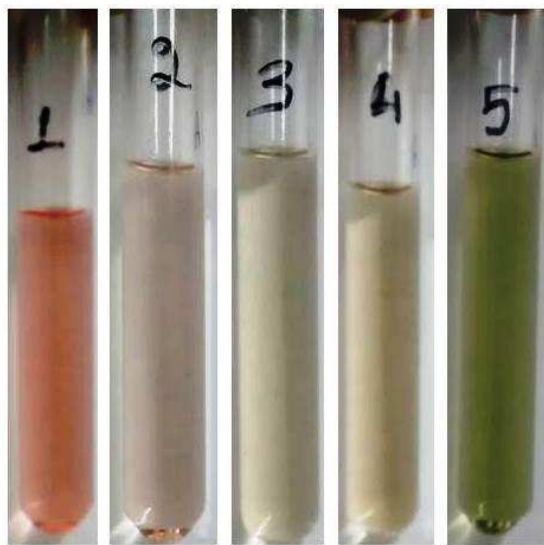
Figura 8. Soluções contendo extrato alcoólico de polpa do fruto da castanhola funcionando como identificador de pH
