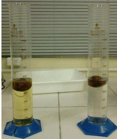
Figura 5. Densidade obtida a partir da imersão do fruto em proveta contendo óleo e água, respectivamente
