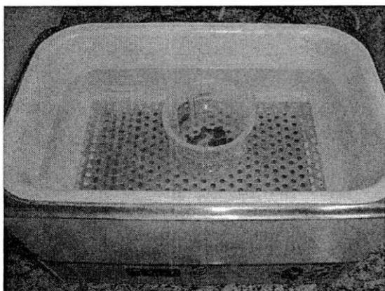
Figura 20 - Ataque químico superficial utilizando-se hidróxido de sódio.
