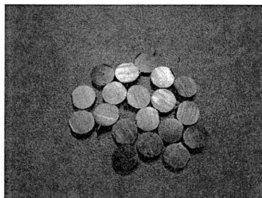
Figura 16 - Polimento das pastilhas de Nitinol em lixa de óxido de alumínio.
