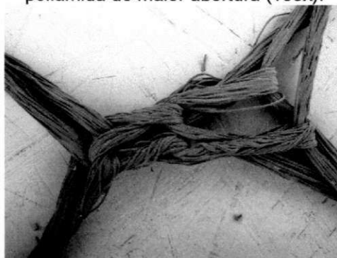
Figura 14 – Micrografia (MEV) do Tule de poliâmida de maior abertura (100x).
