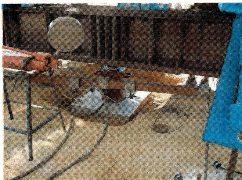
Figura 3.16 – Detalhes do sistema de aplicação de cargas e de medição de recalques da estaca E107.
