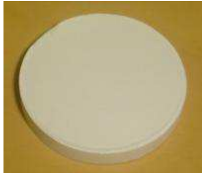
Figura 16. Suporte cerâmico sinterizado a 1200 °C.
