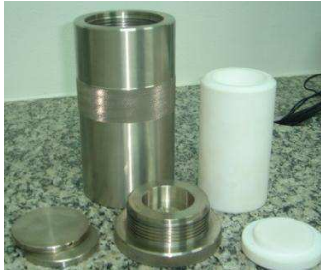
Figura 14. Sistema utilizado na síntese da zeólita MCM-22.
