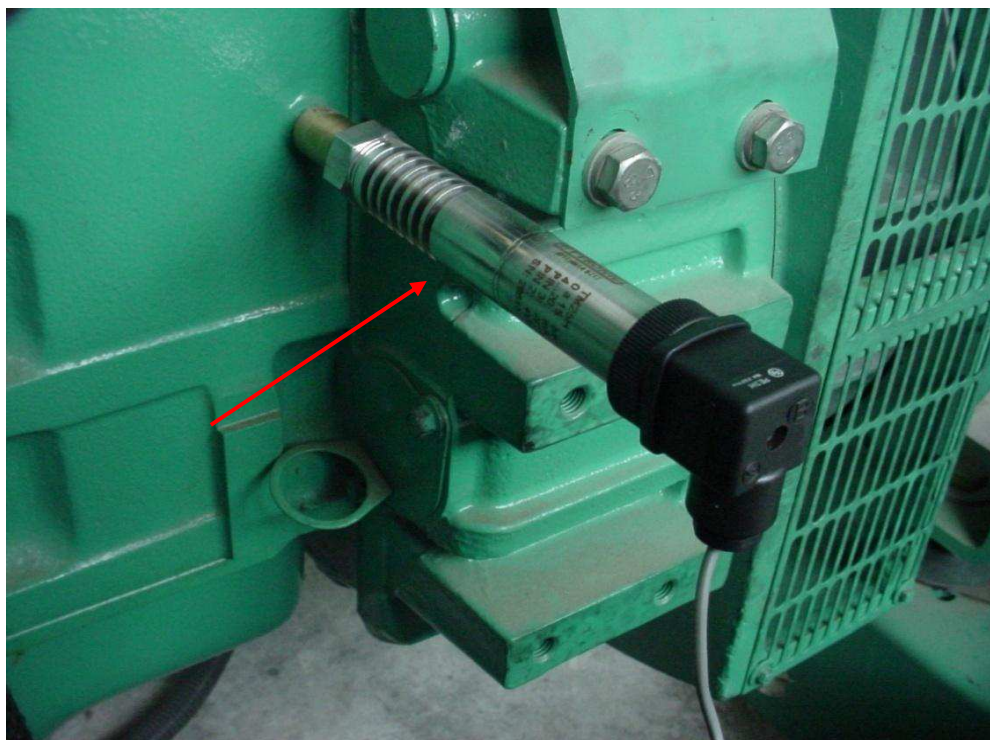
Figura 3.8 - Transdutor para medição da pressão do óleo lubrificante
