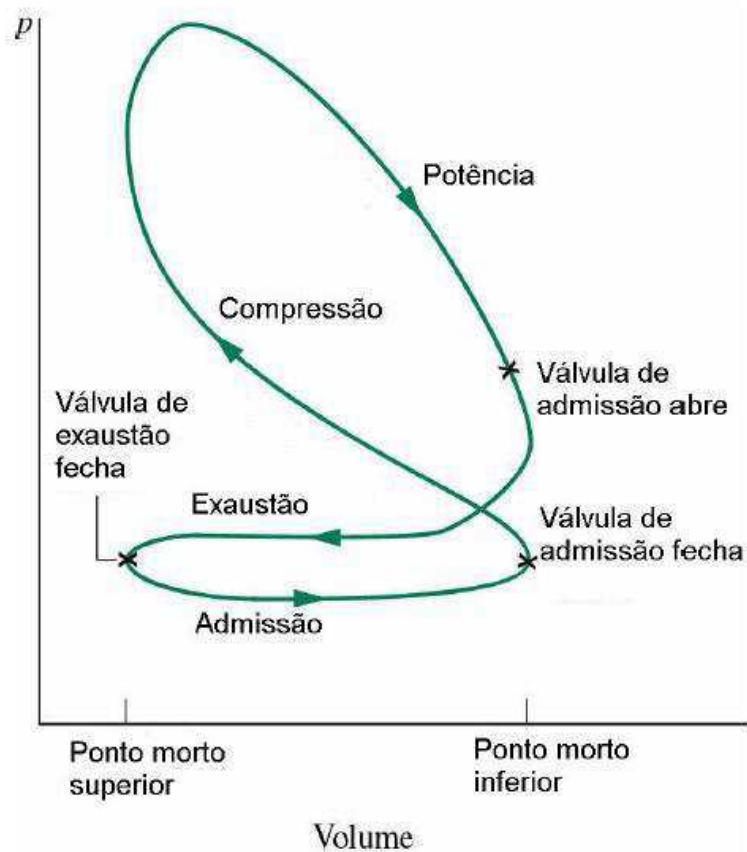
Figura 2.5 - Diagrama pressão-deslocamento para um motor de combustão interna alternativo. Fonte: Moran e Shapiro (2000).
