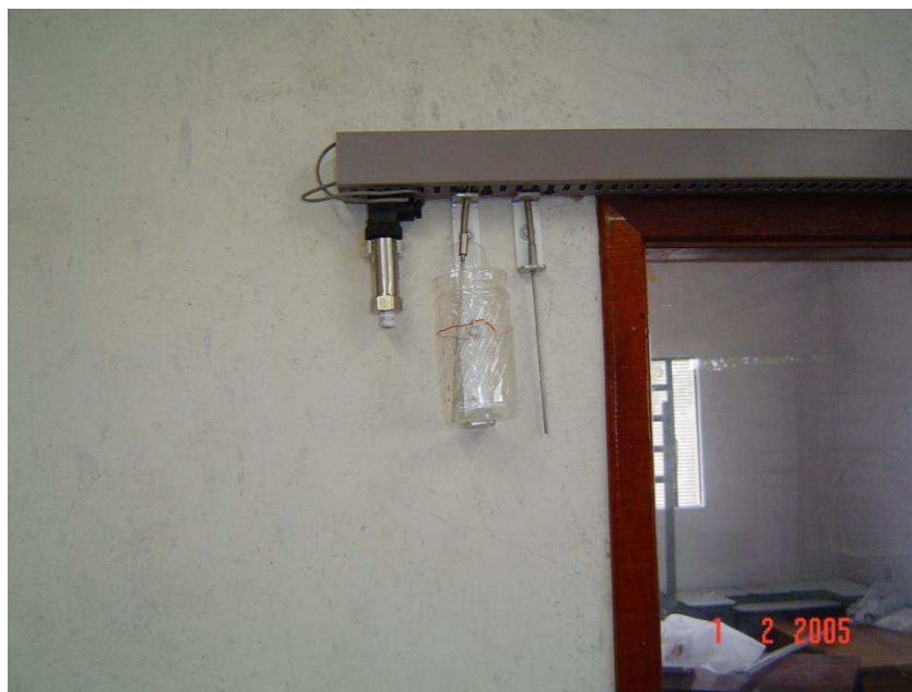
Figura 3.12 - Sistema de medição da condição atmosférica local:transdutor (e) e termopares (d)
